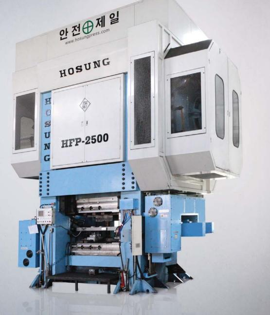
HFP 시리즈는 직기동 방식으로 구동하여 다양한 형태의 단조품을 생산하기에 적합한 온 열간 단조프레스로서 전기종이 고강성의 일 체형 프레임에 타이로드가 삽입되어 강력한 힘을 발휘하며 신율을 최소화하였고, 고정밀로 제작된 슬라이드와 전,후면 모두에서 전,후, 좌,우로 조절할 수 있는 8면 가이드 기브는 고정밀을 실현시켰습니다. 또한 링 기어, 클러치 기어 방식의 클러치구조는 높은 토크 능력 과 디스크 타입을 사용하여 마찰계수를 증대시켜 마모를 최소화하였습니다.
