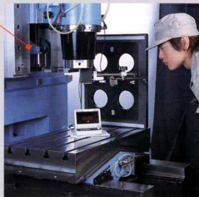
← CMM装置によるYZ平面の真円精度測定
