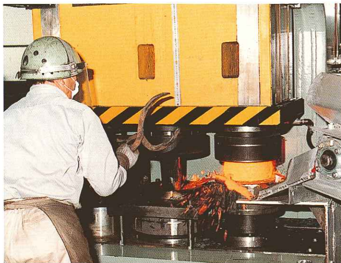
(写真4) 超重量品(55kg)鍛造
