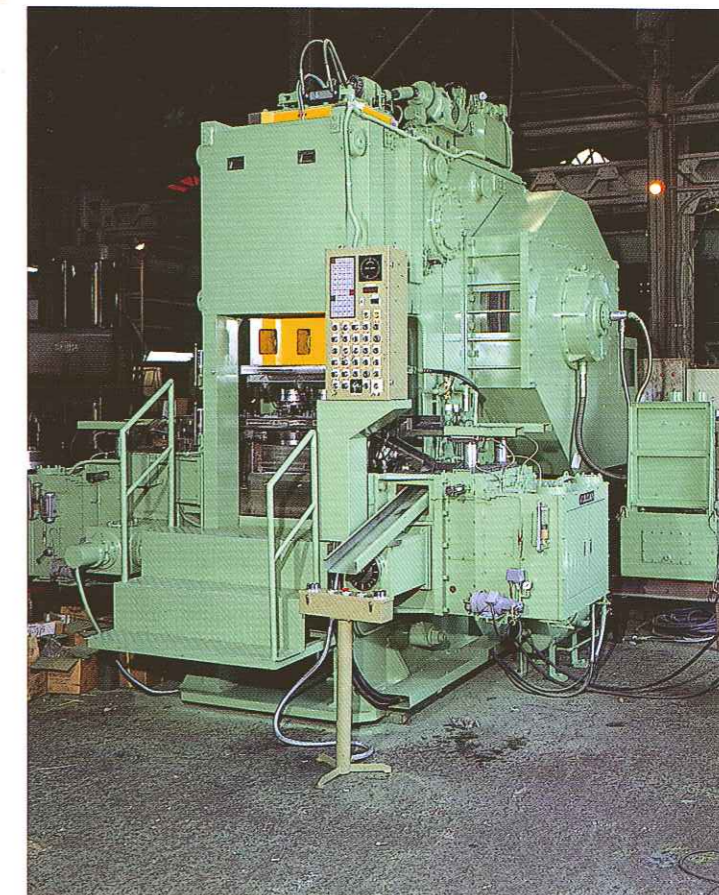
能力600トン 全自動熱間3工程トランスファー
