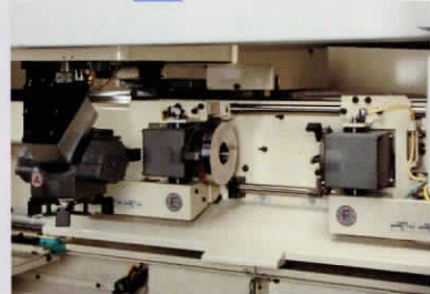
OP10を完了したワークを反転装置のEチャックに取り付け、既にFチャックに反転されているワークを取ります。
