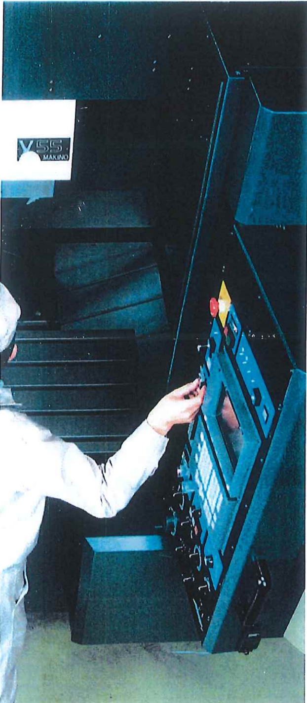
スウィングタイプ操作盤 (0° ~ 90°)
